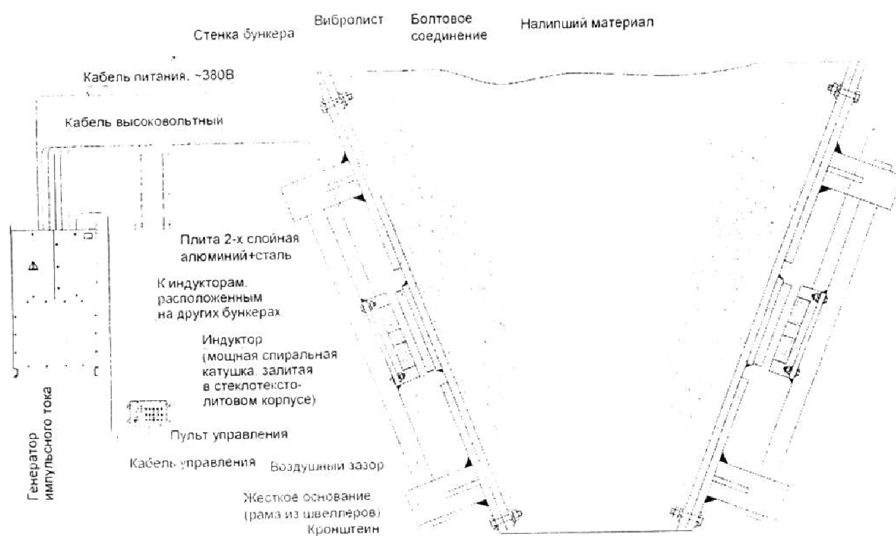
Рис. 2 Размещение исполнительных механизмов на стенках бункера.
