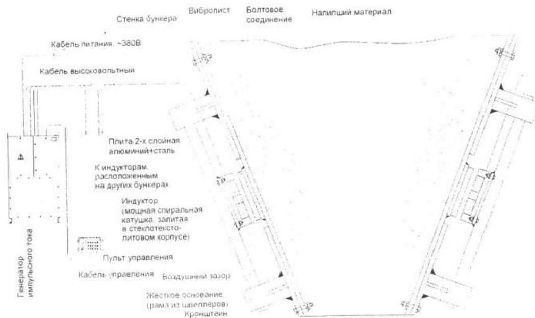
Рис. 2 Размещение исполнительных механизмов на стенках бункера.
